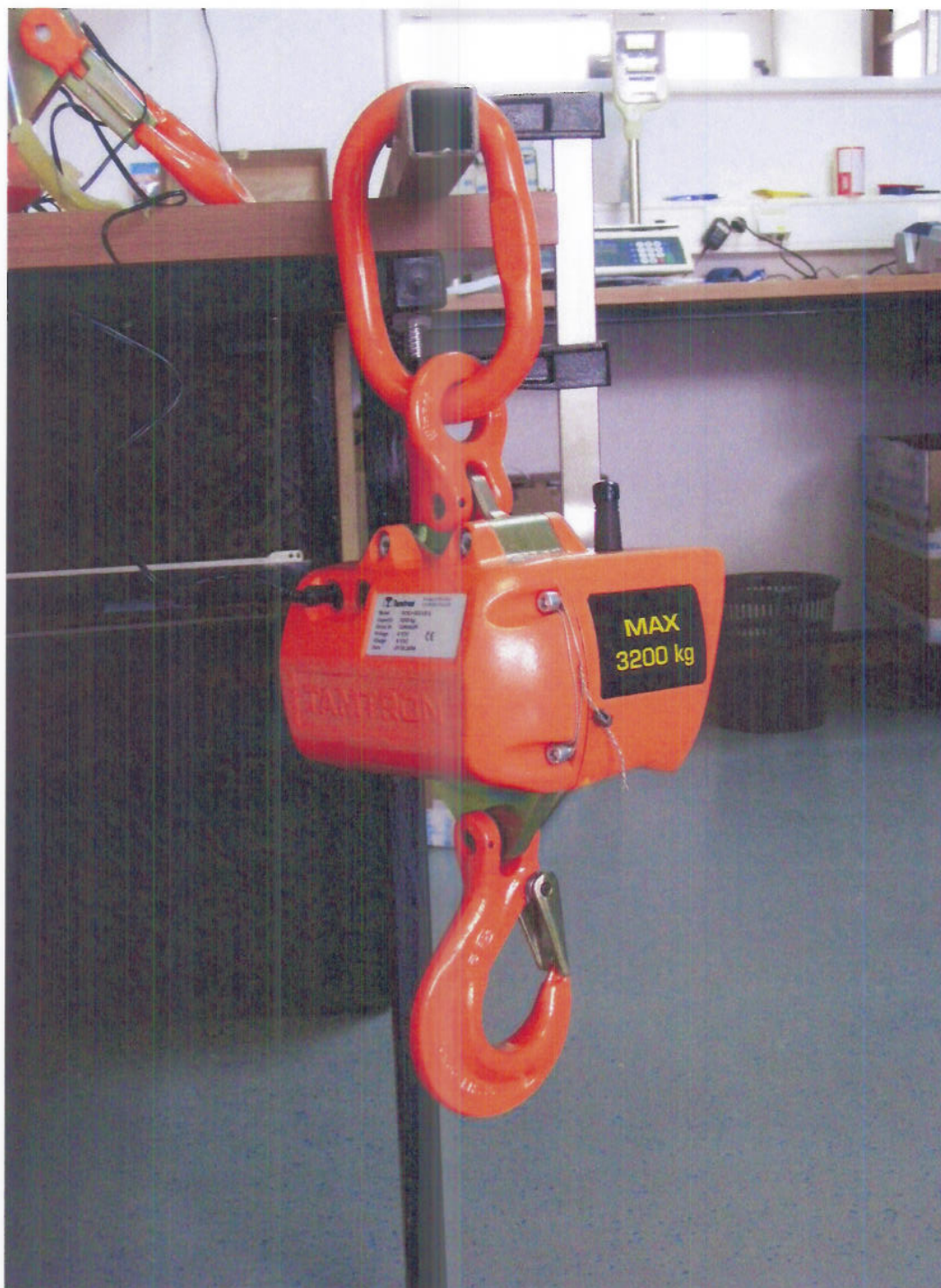
Pogled na stražnju stranu mjerila i smještaj zaštinog žiga u obliku olovne plombe i žice.
